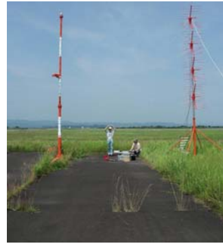
従来のモニタ(左)とアレイ(右)のアンテナ 航空保安大教育用ILSを使用
